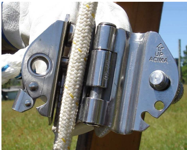
Figura 33 – Instalação do trava-quadras na linha de vida
